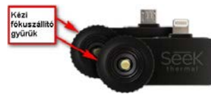
19. ábra: A „Compact” hőkamera modulokon lévő fókuszgyűrűk
