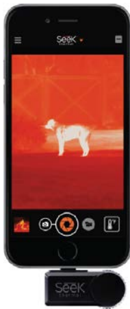
1. ábra: Portré formátumú 4:3-os kijelző beállítással okostelefonra szerelt „Compact” hőkamera modul
