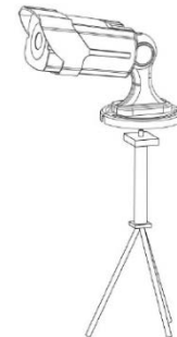
14. ábra: A hőkamera állványra szerelésének sematikus ábrája
